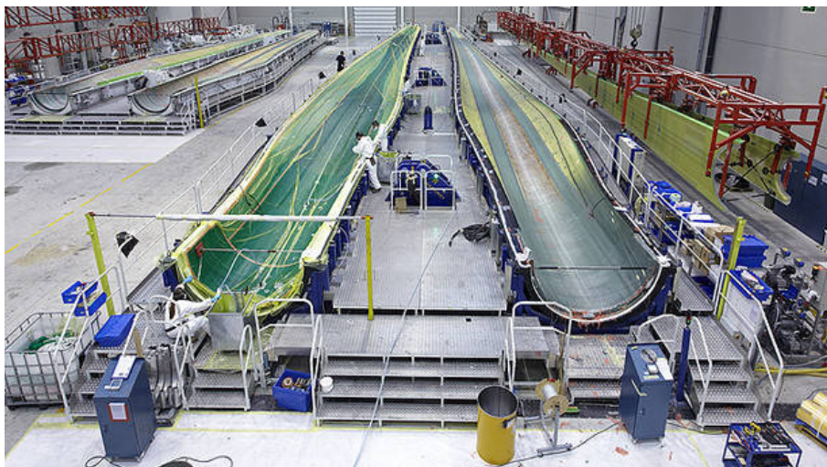
Figura 63: Construcción de palas para turbinas eólicas con procesos industrial RI
