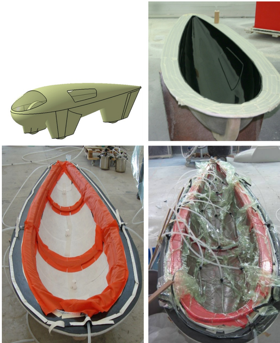
Figura 47: Molde, canales de distribución y venteo para la parte superior del IDEA CEU car , finalmente con la estrategia mostrada en 46.
