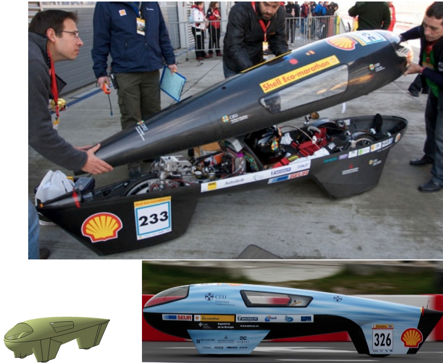
Figura 42: IDEA CEU car, prototipo para una competición de eficiencia energética, con estructura de FRP.
