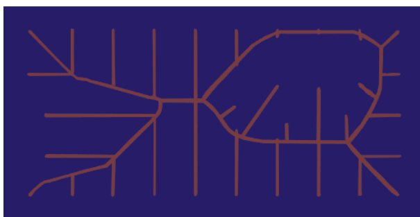
Figura 33: Propuesta final de canales de distribución dispuestos con: canal principal y canales secundarios de tal forma que evitan las zonas sin impregnación.
