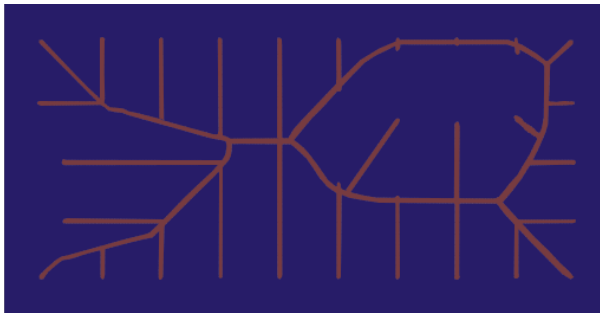
Figura 30: Esquema preliminar del canal de distribución propuesto compuesto de canal principal y secundarios
