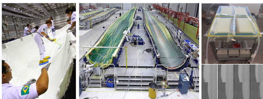
Figura 1: Fabricación de palas de aerogeneradores por Vacuum Assisted Resin Infusion (VARI) (izquierda) proceso en industria, (derecha) reproducción de las condiciones en laboratorio
