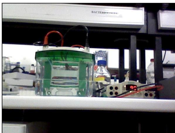
Figura 28. Electroforesis en geles SDS-PAGE
