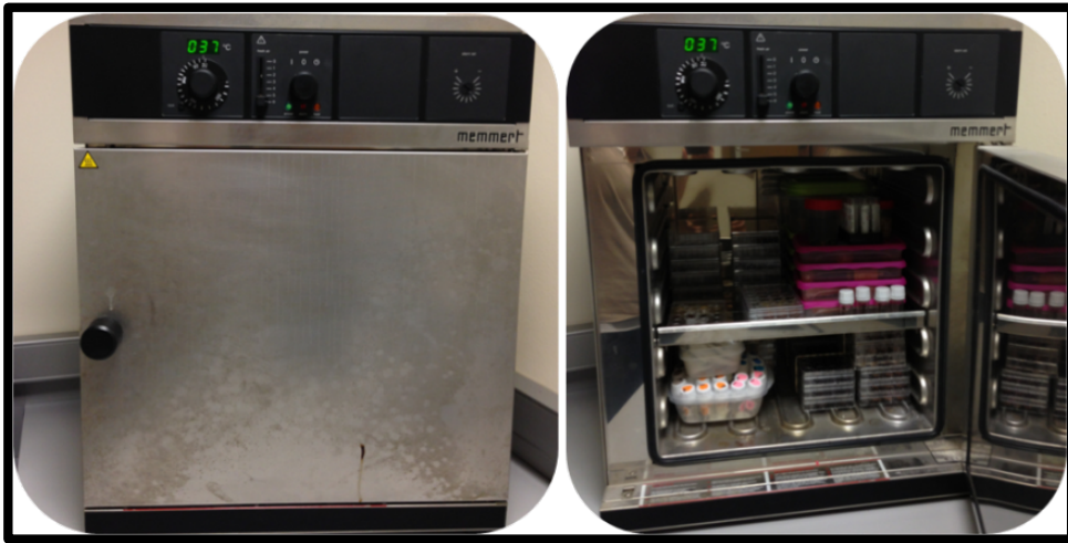
Figura 7. Incubadora Memmert UM400 (Mettler, Schwabach, Alemania) a temperatura constante de 37 \pm 1^\circ\text{C} .
