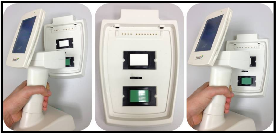
Figura 4. Calibrado del Espectrofotómetro con las placas de color verde y blanco de cerámica.
