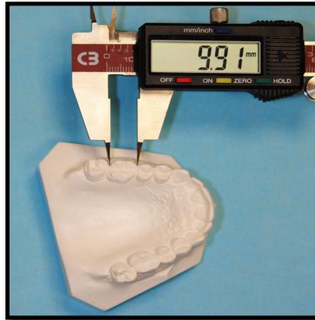
**Figura 8:** Medición del tamaño mesio distal del primer molar superior con el calibre paralelo al plano oclusal.
