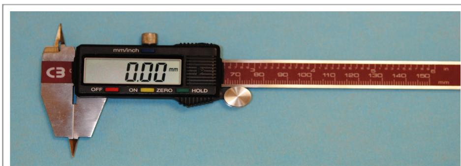
**Figura 6:** Calibre digital de puntas finas utilizado para las mediciones odontométricas.
