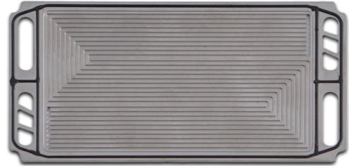
Figura 4.1: Geometría de flujo de gases de la placa diseñada
