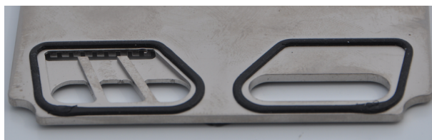
Figura 4.2: Canales de distribución de gases de la placa diseñada
