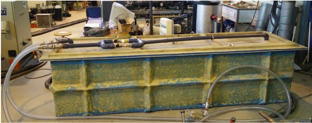
Figura 3.6 Depósito de almacenamiento térmico.
