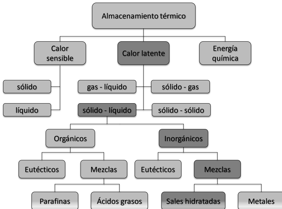
Figura 2.1 Clasificación de los tipos de almacenamiento térmico. Adaptado de Zalba et al [10], Sharma et al. [11] y Abhat [12].
