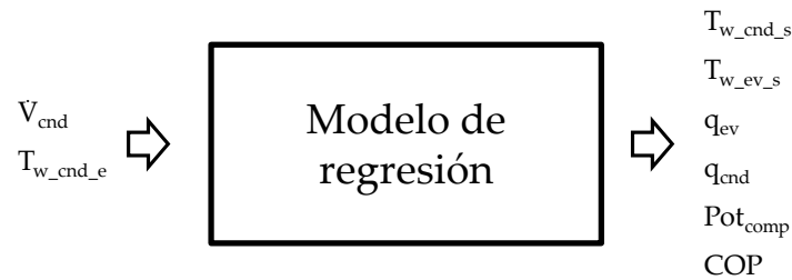
Figura 5.2 Esquema del modelo simplificado propuesto del sistema de compresión de vapor.
