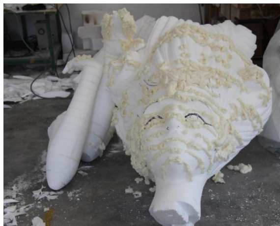
Figura 113: Montaje de figura de poliestireno, con material adhesivo entre láminas. (Fte. Archivo personal)
