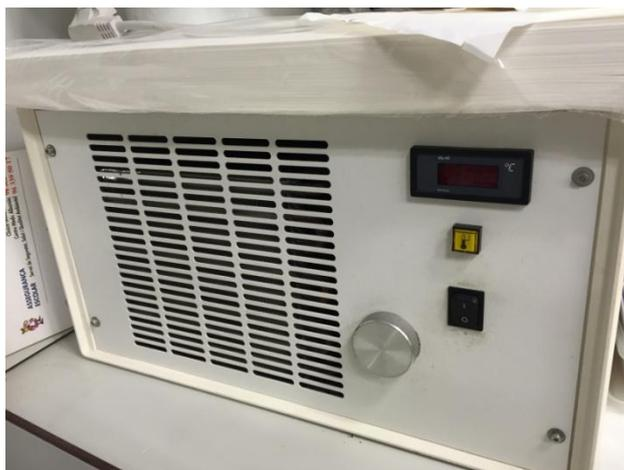
Figura 28. Unidad de congelación acoplada al microtomo de deslizamiento
