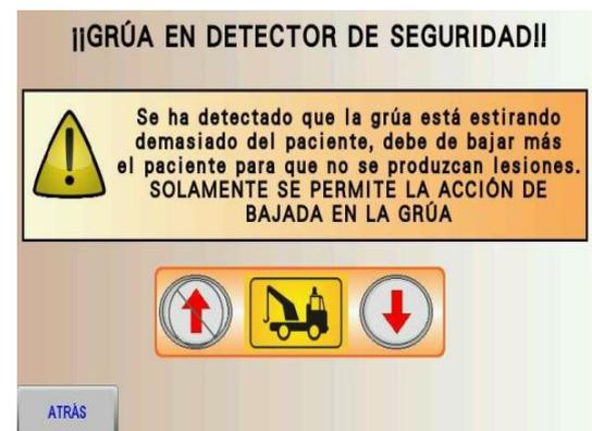
Figura 44. Detector de Seguridad del CL1 Walker
