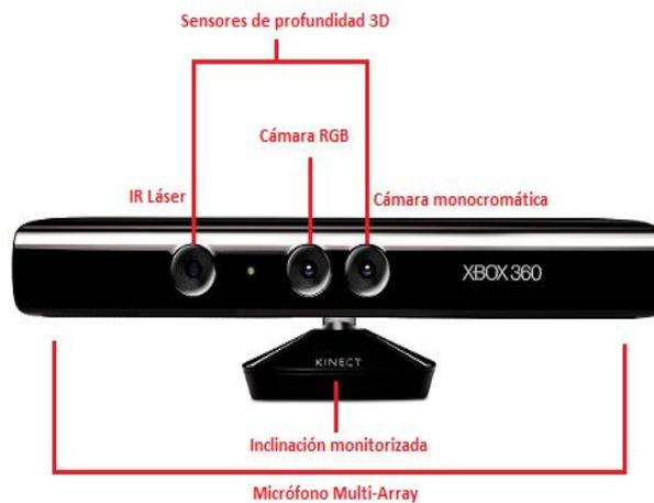
Figura 12. Componentes de Kinect
