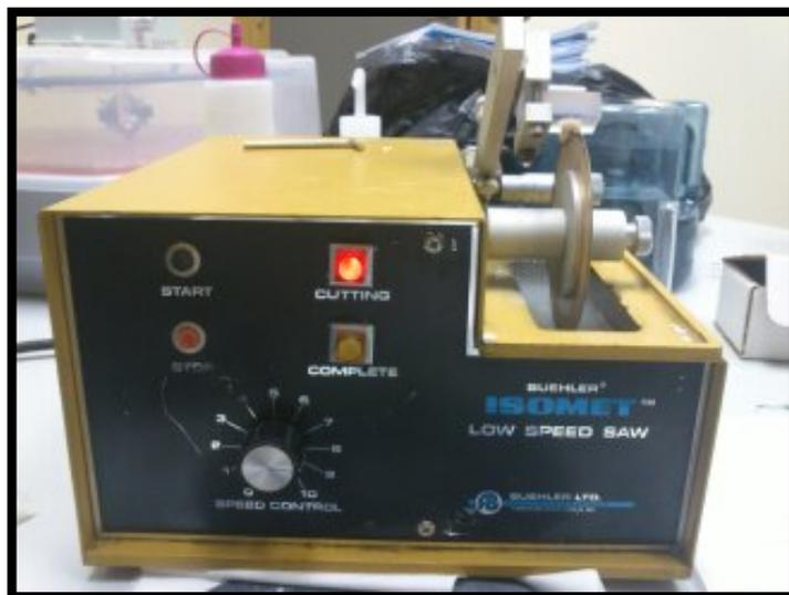
**Figura 5** - Cortadora de precisión a baja velocidad Low Speed saw ISOMET® empleada en el presente trabajo. Isomet™ Low Speed Saw (BUELHER, USA).
