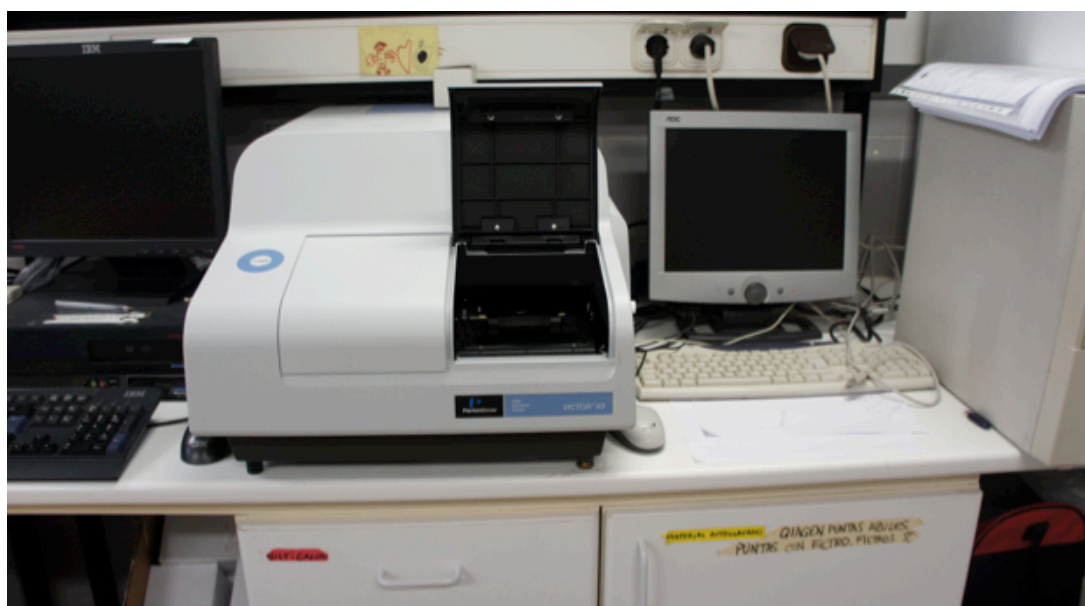
Figura 12: Espectrofotómetro VICTOR X3 (Perkin Elmer) empleado para la lectura de microplacas.
