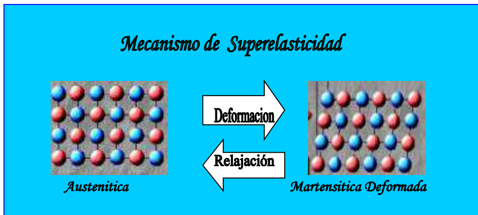
Fig.17 Mecanismo de súper elasticidad.
