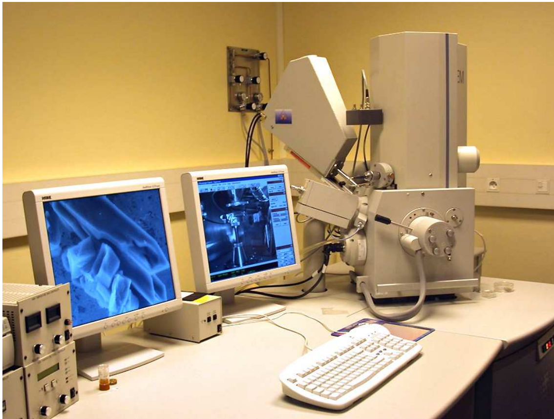
Fig.25 Microscopio Electrónico de Barrido (Philips ESEM XL30).
