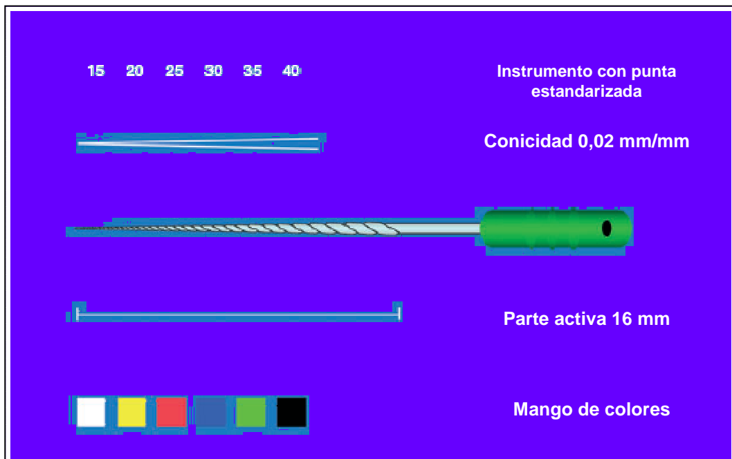
Fig.2 Demostración esquemática de un instrumento ISO Manual de número 35
