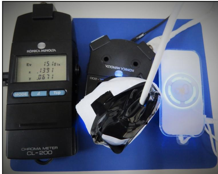
Fig. 36. Comprobación de la irradiancia del dispositivo GLO Brilliant (fuente: autor).
