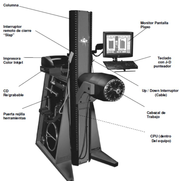
Figura 4: Ejemplo de dinamómetro computarizado. Fuente: BTE Technologies.
