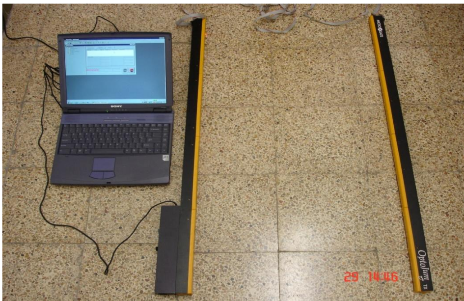
Figura 6. Plataforma de contacto ( Ergo Jump Plus Bosco System ) empleada en la valoración de la fuerza explosiva de los miembros inferiores.
