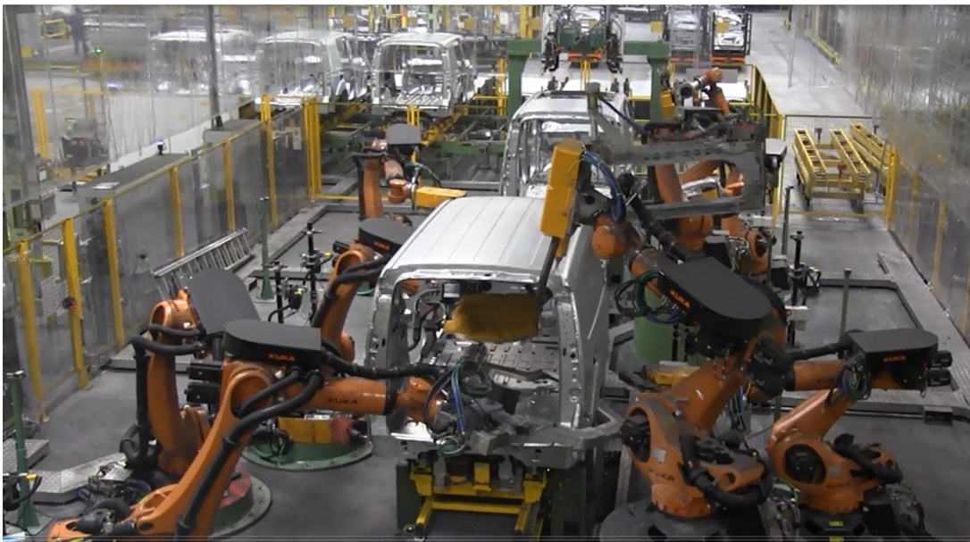
Figura 5 Línea de Soldadura analizada en este capítulo. Está instalada in Ford Factory en Almussafes (Valencia).
