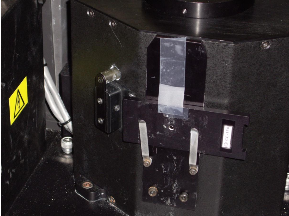
Figura 29. Orificio de entrada de la esfera integradora del espectrofotómetro P-E Lambda 800.
