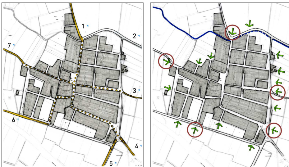
Aperturas viarias del casco urbano de Carpesa que tienen continuidad con la red de caminos rurales Fuente: Elaboración propia a partir de la base cartográfica de Catastro.
