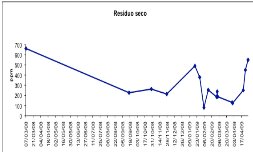
Figura 3.2. Representación de los resultados del parámetro residuo seco, para las muestras de agua de taladrina analizadas desde el 17/09/2008 hasta el 24/04/2009.
