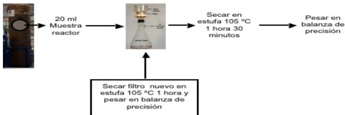
Figura 8.6. Método para determinar la concentración de sólidos en suspensión.
