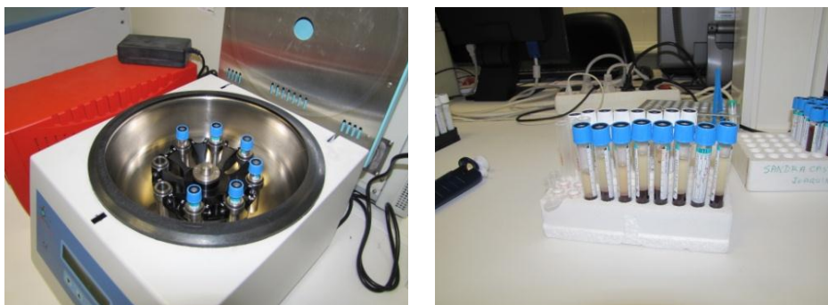
Figura 8: Centrifugación muestras sanguíneas (a); Aspecto del plasma postcentrifugado (b)
