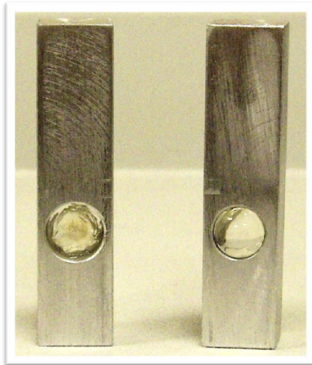
Figura 13.- Portacristalinos utilizado en el estudio. Se observa cómo el cristalino de la izquierda ha sido irradiado con UV, mientras que el de la derecha permanece intacto.
