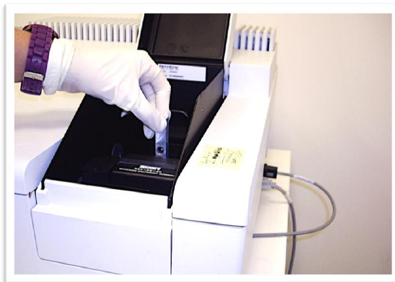
Figura 28.- Colocación de la lente dentro del portacristalinos en el espectrofotómetro para la medida de la transmisión espectral.
