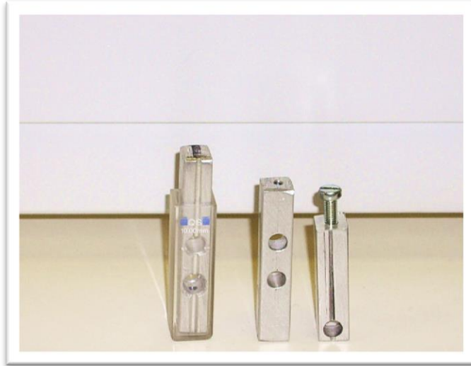
Figura 16.- Portacristalinos para la medida en húmedo con la cubeta transparente correspondiente.
