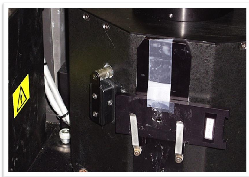
Figura 21.- Orificio de entrada de la esfera integradora del espectrofotómetro P-E Lambda 800.
