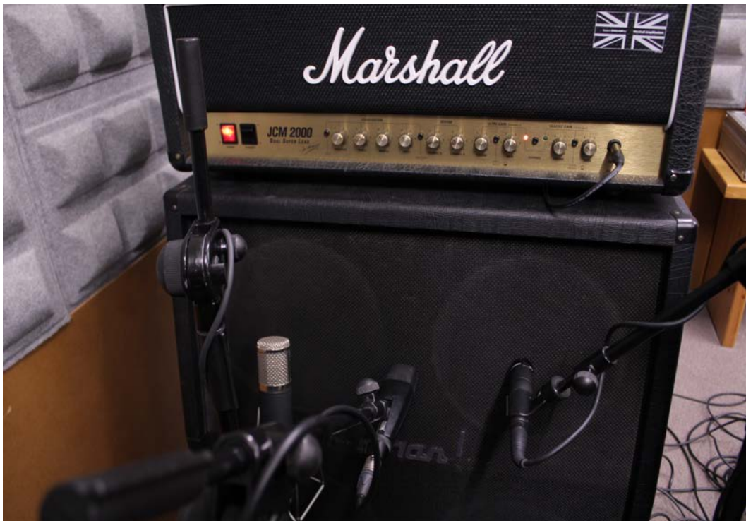
Micrófonos colocados tanto en los conos como en la zona de entreconos de la pantalla
