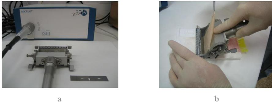
Figura 20. (a) Dermatómetro eléctrico Aesculap-Wagner C. GA 176 utilizado en el proceso de corte de la piel de oreja de cerdo. (b) Corte de piel de oreja de cerdo a 600  $\mu\text{m}$  de espesor.
