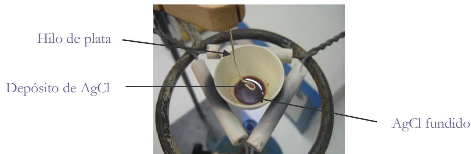
Figura 23. Hilo de plata tras su inmersión en AgCl fundido a elevada temperatura. En el extremo doblado se observa el depósito de AgCl que por repetición del proceso de inmersión dará lugar al cuerpo del electrodo.
