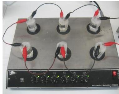
Figura 25. Proceso de plateado de los electrodos  $\text{AgCl}$ .
