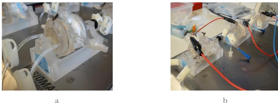
Figura 41. (a) Células de difusión durante un ensayo de permeación pasiva. (b) Células en un experimento de iontoforesis. Todas ellas situadas sobre un multiagitador magnético que mantiene la fase receptora en agitación constante.
