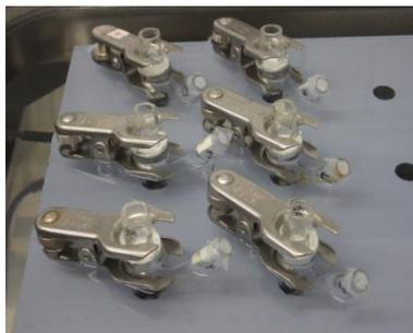
Figura 26. Células de Franz sobre un multiagitador colocado en el baño termostático durante un ensayo de difusión transdérmica.
