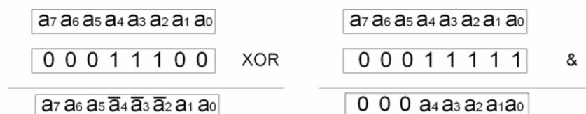
Figura 4.3: Mecanismo para inyectar fallos de tipo inversión y pegado a cero
