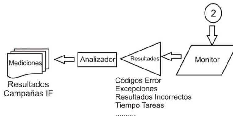
Figura 6.5: Módulo de análisis de los experimentos
