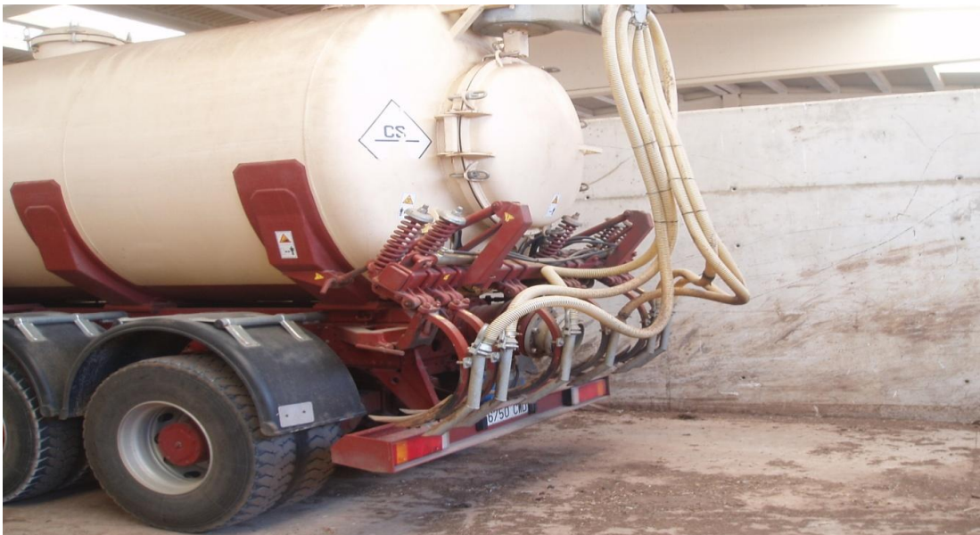
Figura 14. Sistema de aplicación de purines al terreno por inyección subterránea.
