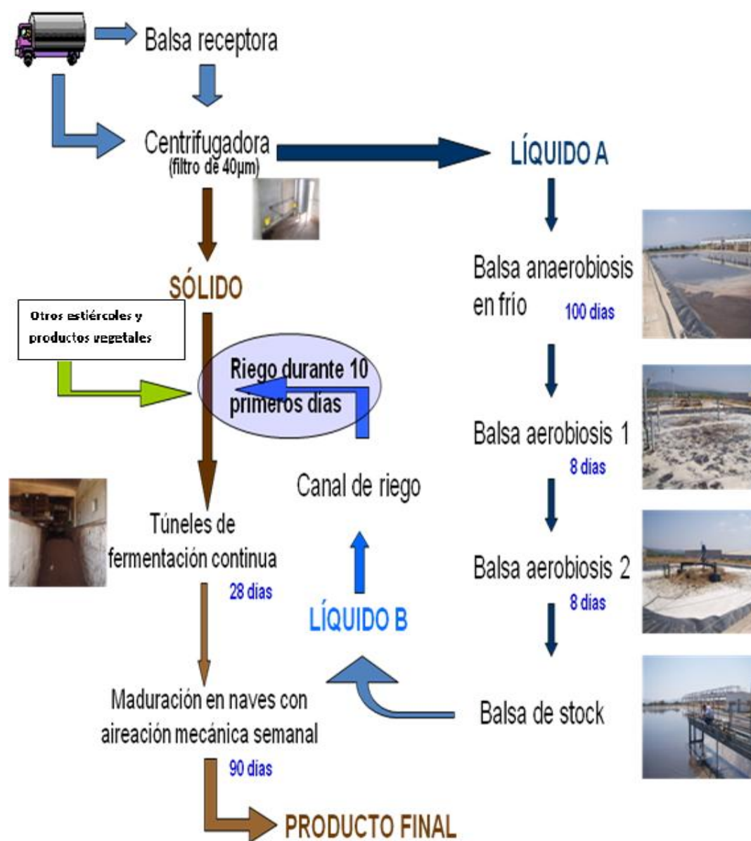
Figura 26. Funcionamiento de la planta con tratamiento integral de purines Vall d'Alba.
