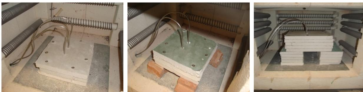
Imagen VII.4 – Validación del apoyo de la probeta de ensayo.
