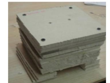
Como puede apreciarse en las anteriores fotografías, la fabricación de la probeta incluyó el montaje previo de la misma para la creación de orificios (con objeto de introducir los termopares posteriormente) mediante un taladro.
