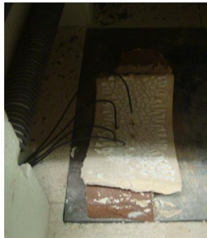
*Imagen VII.2 – Validación de toma de temperaturas en las placas de yeso laminado.*
