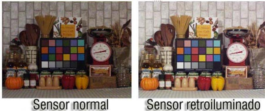
Img. 62: Diferencia con/sin sensor retroiluminado
