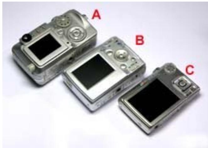
Img. 13: Pantallas de cristal líquido LCD que poseen las cámaras digitales para encuadrar y visualizar las imágenes. A.- pantalla de 1,5 pulgada (ya en desuso). B.- Pantalla de 2,4 pulgadas. C.- Pantalla de 3 pulgadas.
