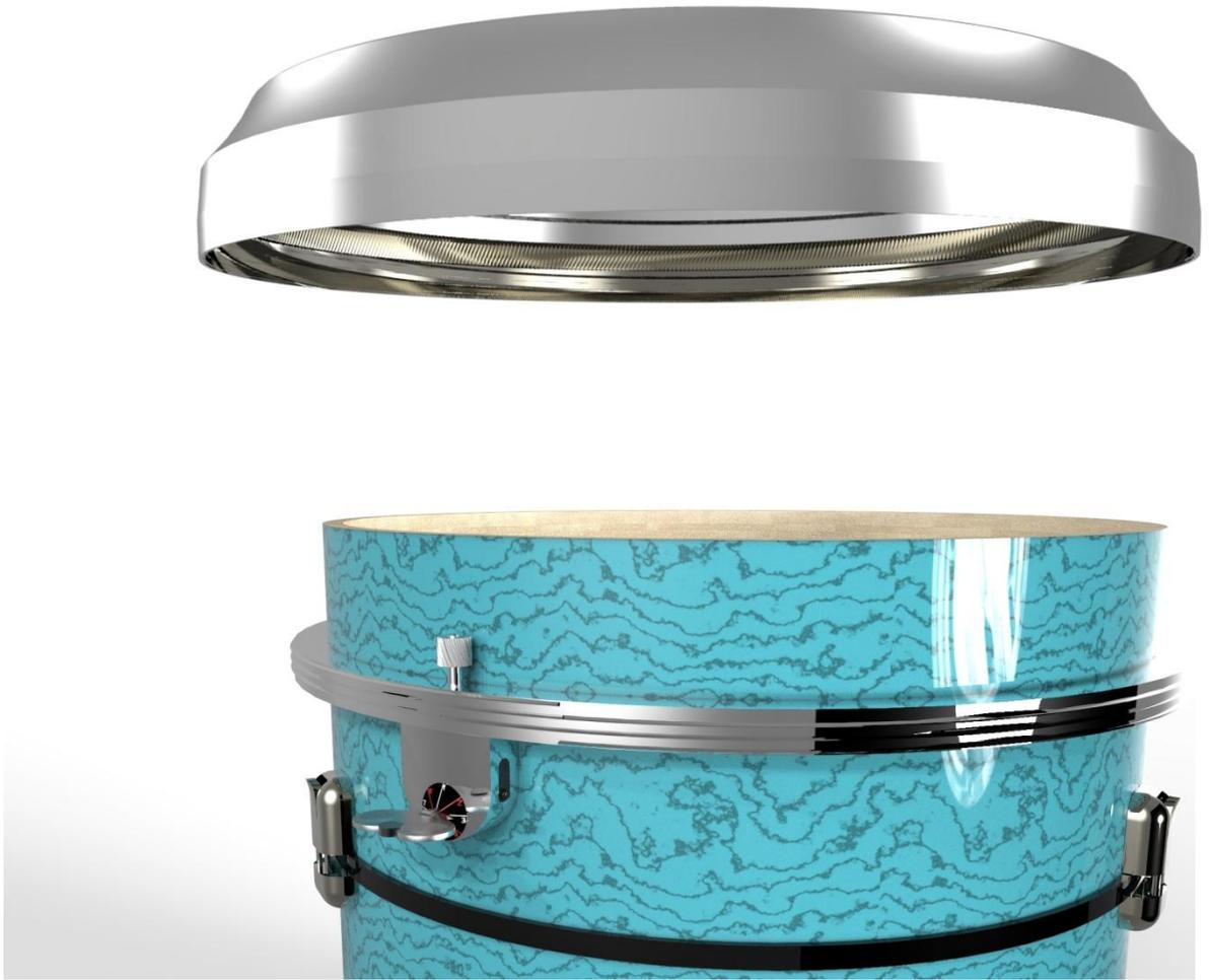
Para accionar el giro del aro se hace servir de una palometa calibrada con una numeración que hace girar un engranaje que este a su vez hace girar el aro, tensando el parche todos por todos los puntos a la vez.
