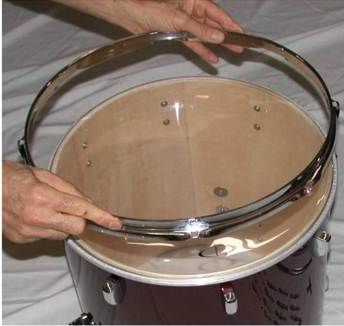
Tensamos el parche con los tornillos tensores, es de vital importancia hacerlo en cruz por que el parche tiene que estar a la misma tensión en todos los puntos.
