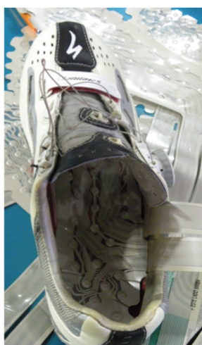
Figuras 9 y 10. Plantilla instrumentada y mapa de registro de presiones plantares.
