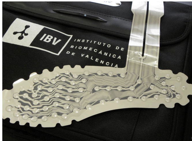
Figura 5. Plantilla instrumentada para medición de presiones plantares.
