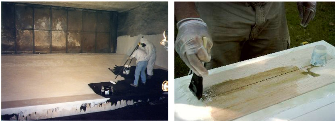
Figura 1-3 Moldeo por contacto a mano (hand lay-up).
