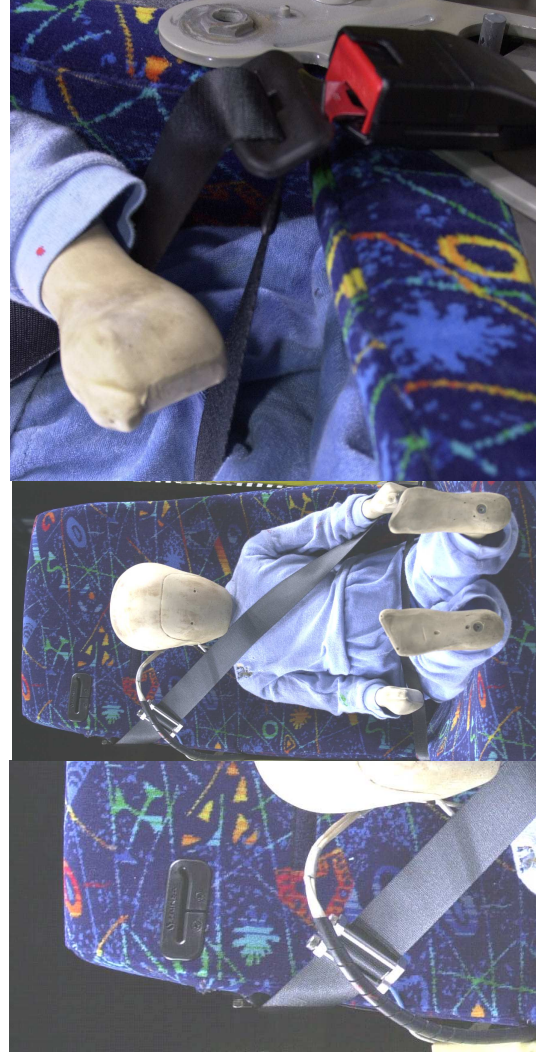
Ensayo 015002Ti: Detalle modificación del reenvío; Vista general de la configuración de ensayo; Detalle de la Hebilla.
