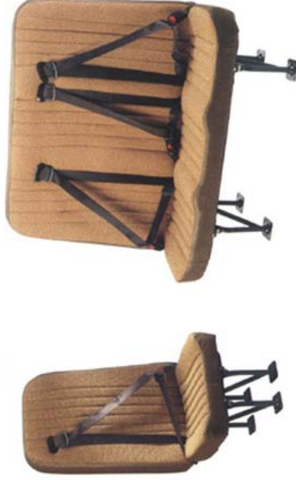
Cinturón de tres puntos integrado en el asiento, con distintas configuraciones
