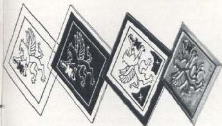
Werdegang einer Strichätzung. Von links nach rechts: Original, das Negativ, die vom Negativ hergestellte seitenverkehrte Metallkopie und die fertige Metallätzung.
