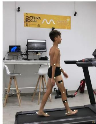
Figura 6. Protocolo Helen Hayes para el análisis de la marcha desarrollado por STSYSTEMS 3DMA.
