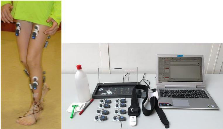
Figura 6. Sistema Freemg de BTS Bioengineering para el análisis electromiográfico de superficie.
