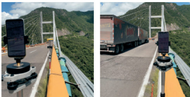
Figura 13. Teléfono Xiaomi Mi8 tomando datos en un puente atirantado.
