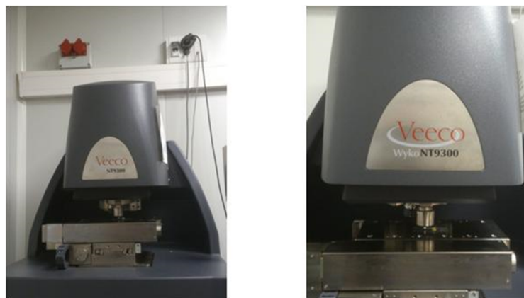
Figura 22: Interferómetro de luz blanca (Optical Profiling System). Imagen obtenida de recursos propios de la Universidad Politécnica de Cataluña
