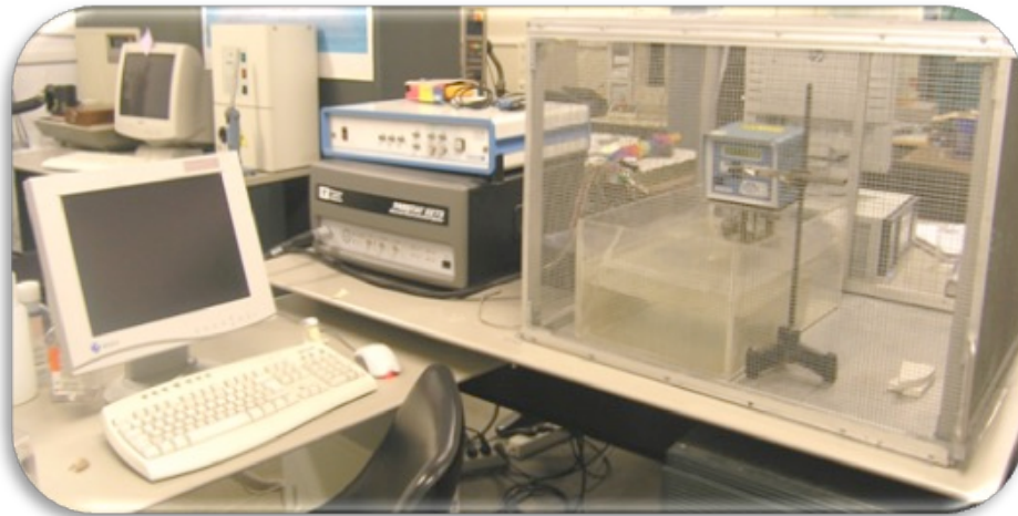
Figura 25: Imagen fotográfica del potencióstato/galvanostato PARSTAT modelo 2273 (Princeton, EE.UU.) utilizado. Imagen obtenida de recursos propios de la Universidad Politécnica de Cataluña.
