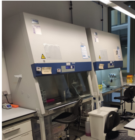
Figura 23: Campanas de flujo laminar para los ensayos de biológicos y microbiológicos. Imagen obtenida de recursos propios de la Universidad Politécnica de Cataluña.
