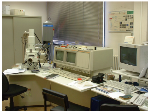
Figura 21: Microscopio electrónico de barrido SEM modelo "JSM-6400 Scanning Microscopy". Imagen obtenida de recursos propios de la Universidad Politécnica de Cataluña.
