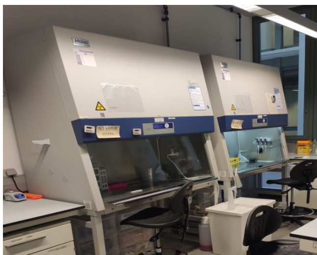
Figura 23: Campanas de flujo laminar para los ensayos de biológicos y microbiológicos. Imagen obtenida de recursos propios de la Universidad Politécnica de Cataluña.
