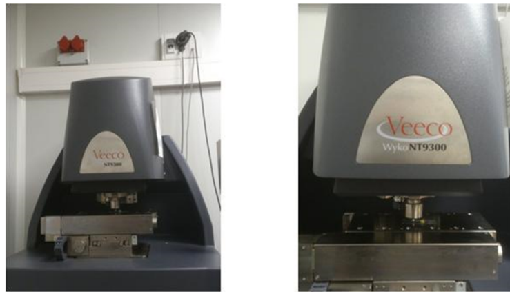
Figura 22: Interferometro de luz blanca (Optical Profiling Sistem). Imagen obtenida de recursos propios de la Universidad Polit cnica de Catalu a.
