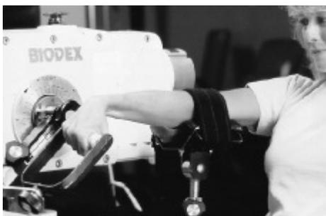
Figura 5. Dinamómetro isocinético. El eje del equipo y del movimiento del sujeto deben ser coincidentes para la evaluación correcta.
