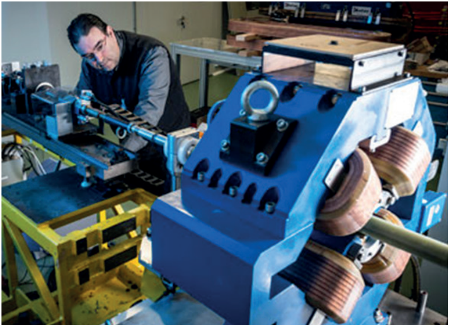
Figura 3. Ejemplo de imán cuadrupolar utilizado en ALBA para enfocar los electrones y transportarlos a través de largas distancias.
