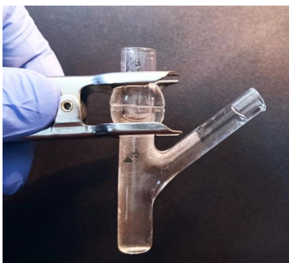
Figura 5. Celda de difusión. Imagen de elaboración propia.
