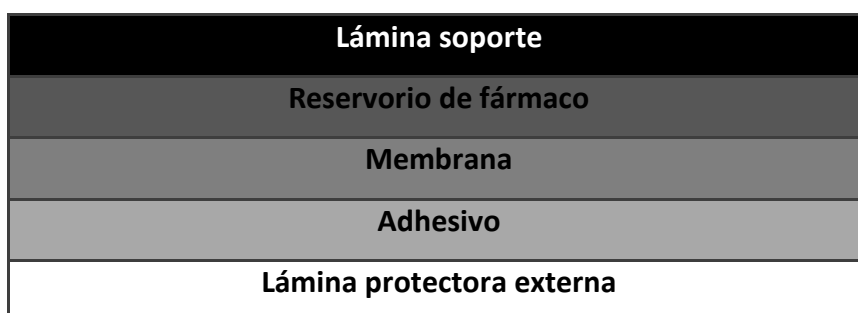
Figura 9. Sistema terapéutico de administración transdérmica de tipo reservorio o membrana.
