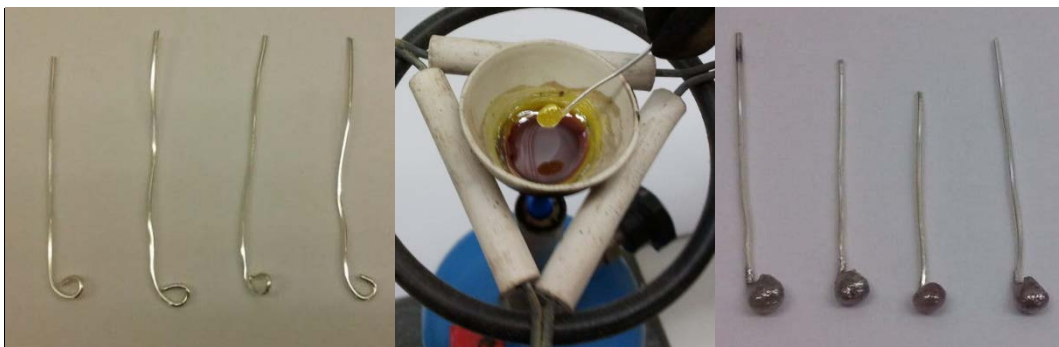
Figura 16. Proceso de fabricación de los electrodos AgCl.
