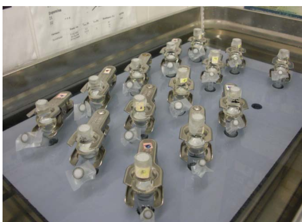
Figura 15. Células de Franz sobre un multiagitador durante un ensayo de difusión transdérmica.
