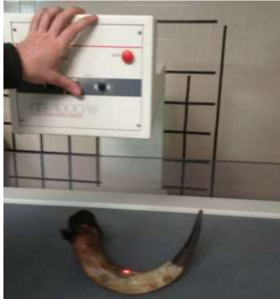
Figura 3. Localización del punto medio del cuerno mediante laser
