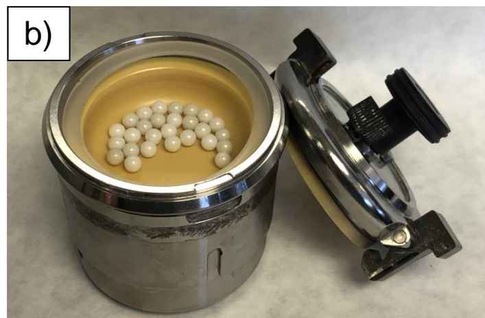
Figura 3.2. a) Molino planetario Fritsch modelo Pulverisette 7; b) Tarro de molienda con bolas de circonia en su interior.
