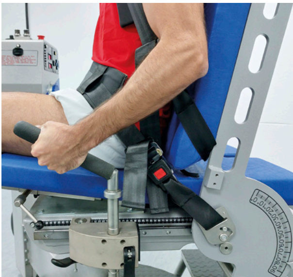
Figura 10. Detalle de la inclinación del respaldo del asiento del dinamómetro. Obsérvense las cinchas y velcros que permiten fijar al jugador al respaldo, así como las empuñaduras laterales.
