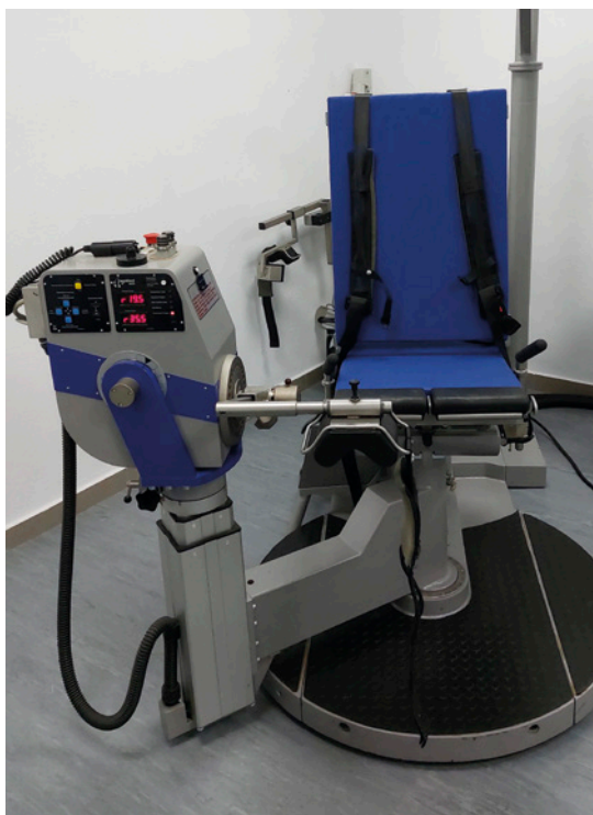
Figura 4. Unidad central y brazo giratorio del dinamómetro isocinético.
