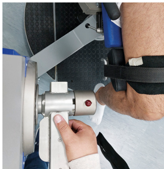
Figura 6. Detalle del láser ubicado en el brazo giratorio que permite la alineación correcta del eje articular.
