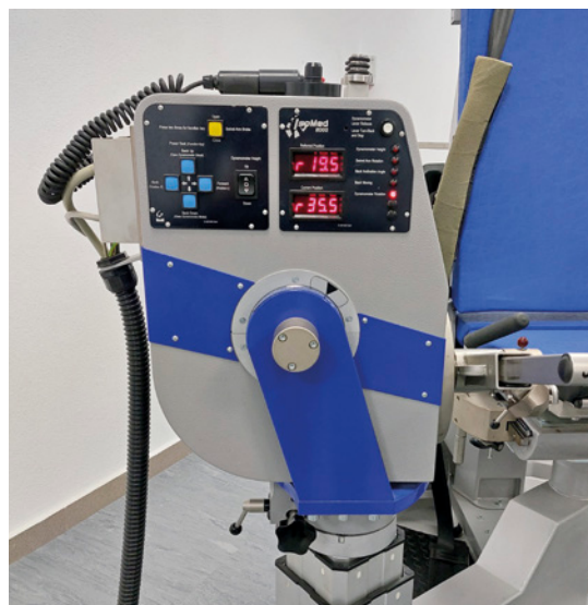
Figura 5. Detalle del brazo giratorio con los botones y palancas de ajuste.
