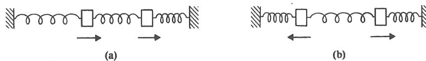
Figura 38. Modos normales de un oscilador de dos masas. (a) En el modo de baja frecuencia las masa se mueven en la misma dirección (b) En el modo de alta frecuencia las masas se mueven en direcciones opuestas [3].
