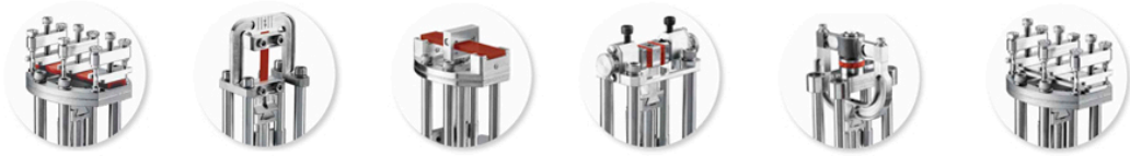
Figura 22. Diferentes tipos de configuraciones para el DMA test [115].
