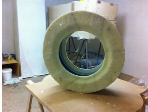
Figura 73. Molde GFRE desarrollado para la fabricación del casco del membranófono.
