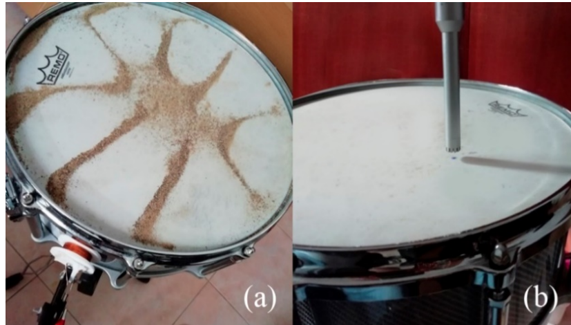
Figura 109. (a) Comprobación de la regla de acoplamiento modal mediante el patrón de Chladni, acoplamiento (4,1,0) a 683,60 Hz. (b) Posición del micrófono de medición utilizado en la validación experimental.
