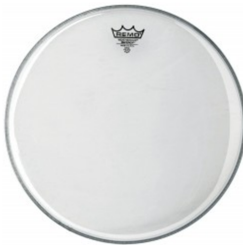
Figura 10. Membrana de 14" de Remo Drumheads (USA). La pieza termoformada de Mylar está unida mediante adhesivo al aro metálico exterior.
