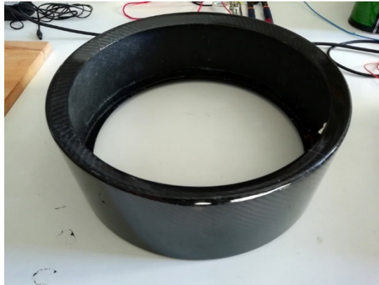
Figura 84. Casco de fibra de carbono reforzado con epoxi CFRE creado para la validación experimental.
