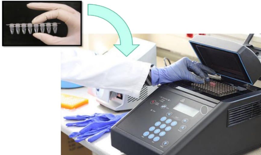
Figura 4. Termociclador. Permite el cambio brusco y rápido de temperaturas. Fuente: modificada de Wikipedia, Reacción en cadena de la polimerasa, y iStock.
