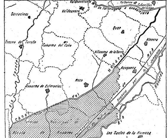
El trazo grueso y continuo señala la parte ya construída del canal del Henares, que se halla en mal estado, y termina en el límite de Guadalajara y Madrid; la continuación del trazado, la parte que se ha de construir (12 kms.). La zona rayada indica la superficie de la provincia de Madrid que regará el canal, y lleva rayado diferente en cada término municipal (Meco, Camarma y Alcalá). En Guadalajara serán varios los pueblos beneficiados.
