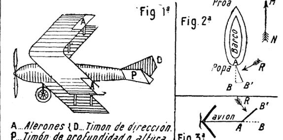
A...Alerones D...Timón de dirección. P...Timón de profundidad o altura. Fig 3a
