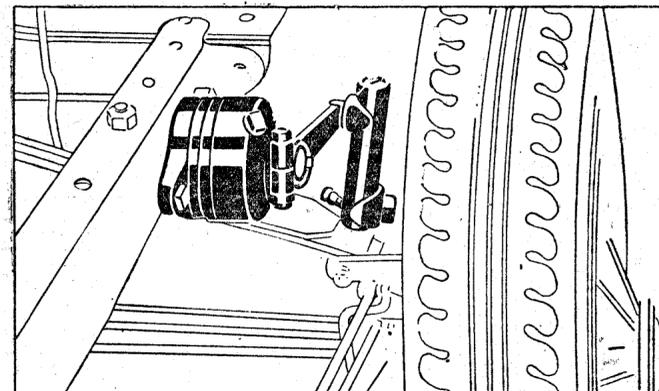
Detalle del amortiguador
