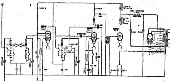
Circuito típico de 3 válvulas para corriente alterna con las nuevas válvulas metálicas "KATKIN" Gecco, que representa Empresas Radio Eléctricas, Poligros, 2.
