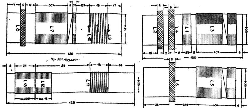
Detalles parciales del esquema Tungsram para la construcción de un superheterodino universal, toda onda, con regulación antifading, publicado en nuestra página del pasado martes
