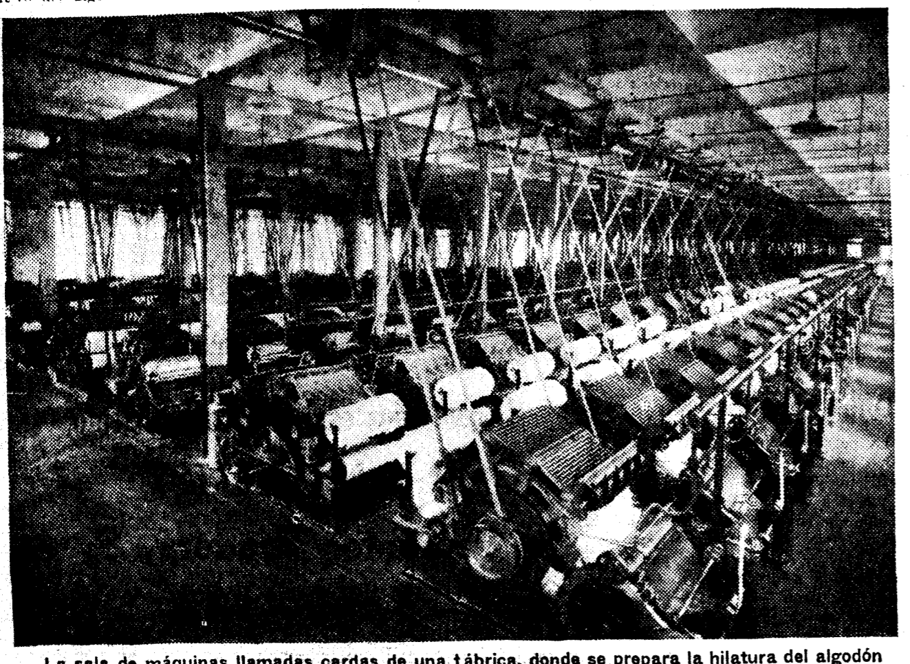
La sala de máquinas llamadas cardas de una fábrica, donde se prepara la hilatura del algodón
